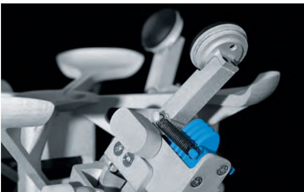
Selbstlernend: Die vier pneumatischen Finger des LearningGripper ...
