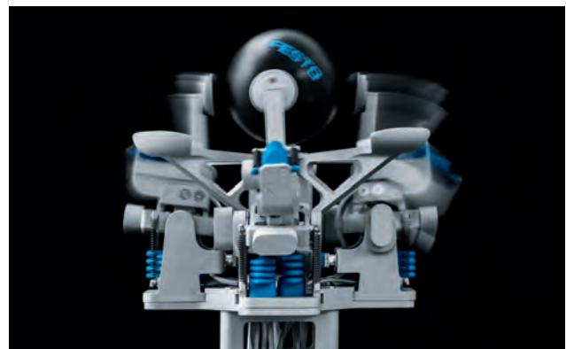
... orientieren die Kugel, bis die richtige Seite oben liegt
